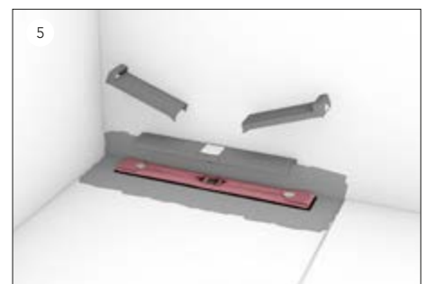
Nach dem Verfüllen mit Estrich wird der Bauzeitschutz entfernt, die erste Schicht der Verbundabdichtung aufgetragen...
