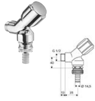
DIANA Geräteschrägsitzventil 1/2" mit RB ohne ASAG Sicherungskombination gem. EN1717 mit Rückflussverhinderer, Belüfter und Schlauchverschraubung, Prüfzeichen P-IX 007/1, DVGW zertifiziert, Dimension DN 15 G 1/2 AG, verchromt, (DI407910500) 67,- €
