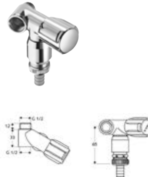
DIANA Nebenanschlußventil mit RV, RB ohne ASAG 1/2" mit Rückflussverhinderer, Rohrbelüfter und Schlauchverschraubung, Prüfzeichen: DVGW zertifiziert, Dimension: DN 15 G 1/2 AG x G 1/2 IG, verchromt, (DI407921500) 106,- €
