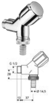
DIANA Geräteschrägsitzventil ohne RB und ASAG mit Rückflussverhinderer und Schlauchverschraubung, Dimension DN 15 G 1/2 AG, verchromt, (DI407911500) 60,- €
